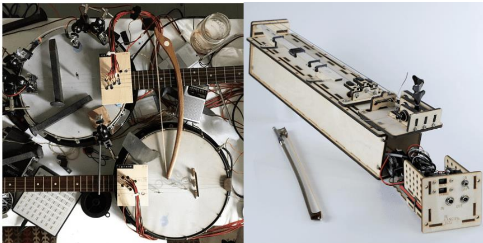
Mynd 1 og 2: Til vinstri: Rafstýrðu banjóin sem notuð eru í a vine that grew over the city and no one noticed . Til hægri: Hið íslenska Proto-langspil úr smíðju Intelligent Instruments Lab.
